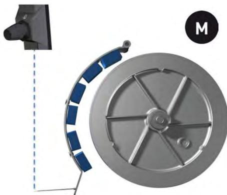
При повороте регулятора, магнит приближается к маховику, тем самым усиливается торможение и нагрузка
